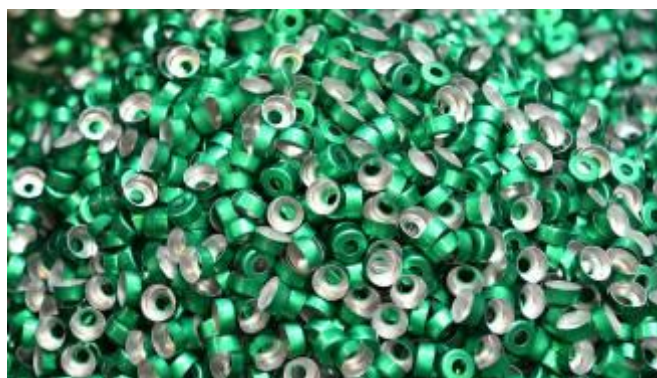
EMA Pharmaceuticals fabrique un milliard de capsules par an : elle emboutit l'aluminium, sous-traite le plastique et assemble le tout.
